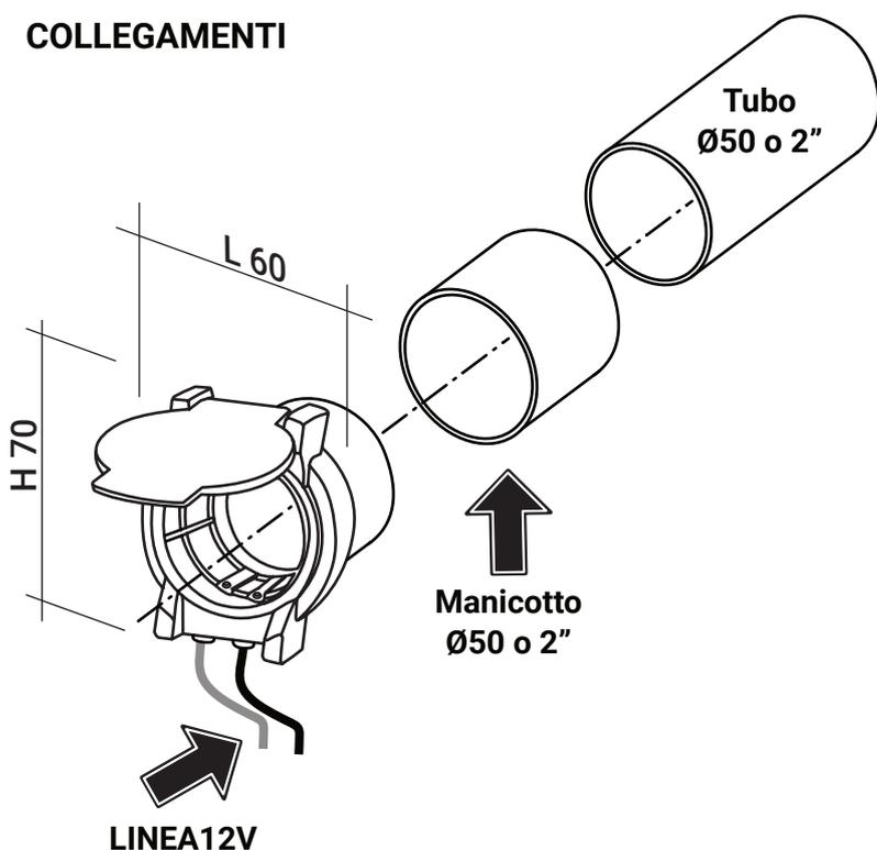
Il fissaggio avviene direttamente sulla tubazione con raccordo femmina Ø50 o 2\"
